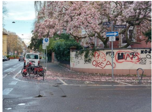
Abbildung 11: Bodenmarkierungen in Kreuzungsbereichen (links) und vorgezogene Seitenräume (rechts)
