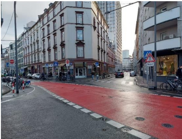
Abbildung 11: Bodenmarkierungen in Kreuzungsbereichen (links) und vorgezogene Seitenräume (rechts)
